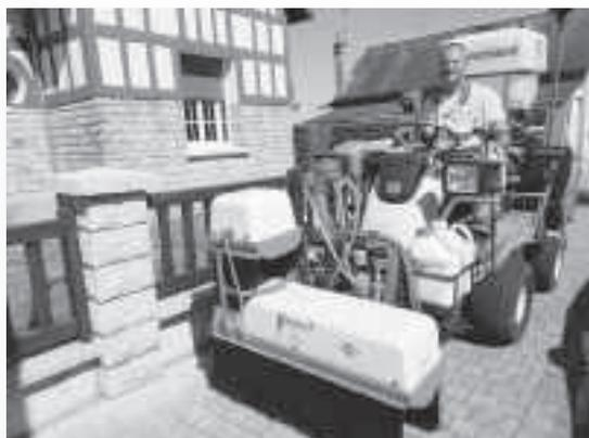
Elle sillonne depuis un certain temps nos rues et trottoirs, déploie ses bras de temps à autre, c'est la « **weed-it** ». Plus sérieusement, c'est une machine intelligente qui, par un système de détection de la chlorophylle, permet de pulvériser uniquement sur les mauvaises herbes, d'être très économe en produits phytosanitaires et de protéger notre environnement (nous sommes passés de 200 l à 40 l de produit).
